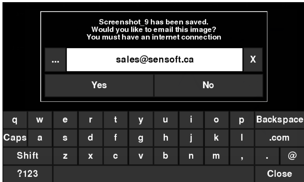
Obrázek 7-2: Zpráva po stisknutí tlačítka Fotoaparát na zobrazovací jednotce pro zachycení obrazovky s povolenou Wi-Fi a připojením k bezdrátové síti. Uživatel může zadat e-mailovou adresu, na kterou se má odeslat minizpráva.
