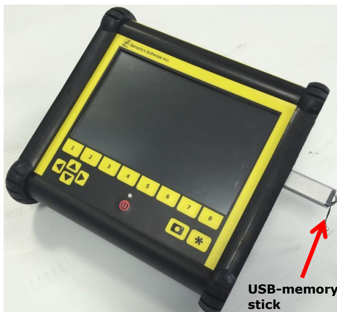
Obrázek 8-1: Vložte USB flash disk do USB portu na jednotce displeje, abyste mohli exportovat údaje.
