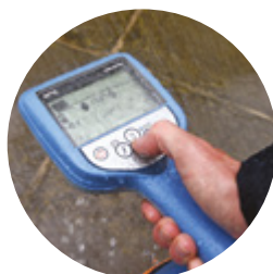
Funkce pro rozlišení přeindukovaných signálů z cizích sítí
