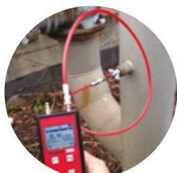
Jednoduchý tlakoměr pro měření tlaku a podtlaku vzduchu/plynu
