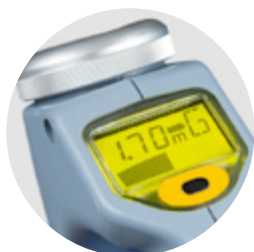
Měření hloubky uložení potrubí
