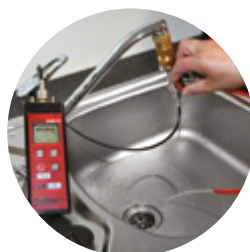
Nejen měření tlaku plynu, ale i tlaku vody
