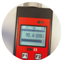
Rozsah měření koncentrace plynu až do 100 %OBJ.
