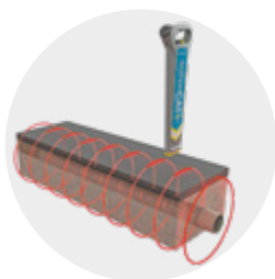
Model CPS pro trasování katodicky chráněných plynovodů
