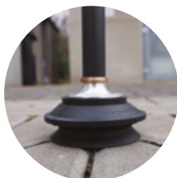
Kroková sonda pro detekci úniků z podzemních plynovodů
